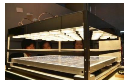
図2 PV パネル評価装置
